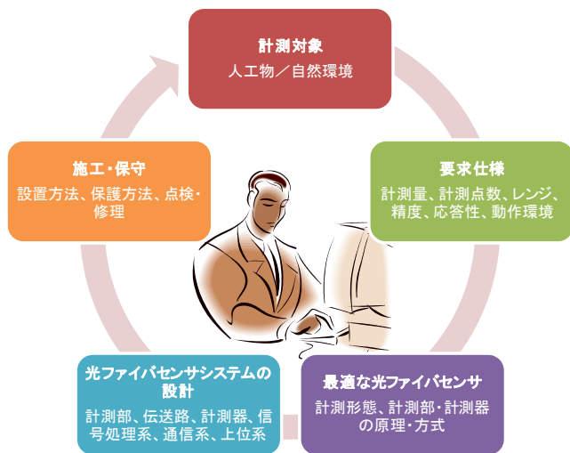
図7 光ファイバセンサの構築
